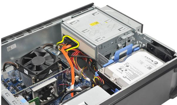
4. Puxe o trinco de desbloqueio da unidade óptica e depois empurre a unidade óptica em direcção à parte frontal do computador.
