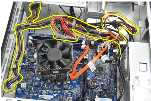
8. Retire os parafusos que fixam a fonte de alimentação ao computador.
