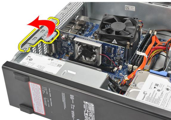
4. Pressione a alavanca de desbloqueio para soltar a patilha de fixação do entalhe na placa.
