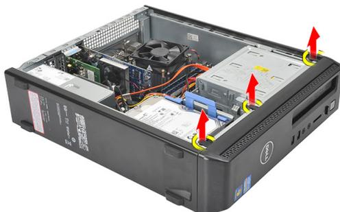
4. Rode e retire a moldura frontal do computador para soltar do chassis os ganchos existentes na extremidade oposta da moldura.
