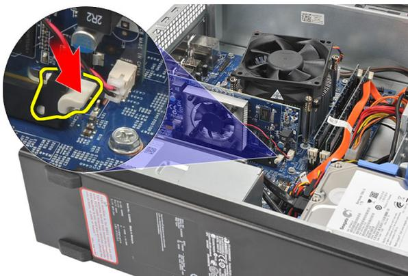
5. Levante a placa de expansão para fora do respectivo conector e retire-a do computador.
