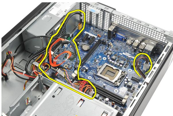
10. Retire os parafusos que fixam a placa de sistema ao computador.
