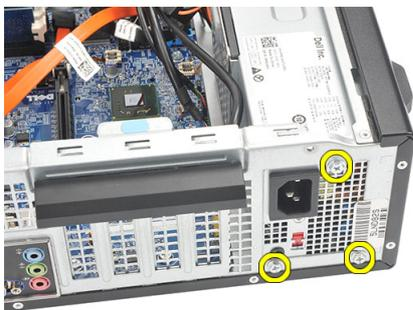
9. Carregue na patilha de desbloqueio azul junto à fonte de alimentação, e faça deslizar a fonte de alimentação em direcção à parte frontal do computador.
