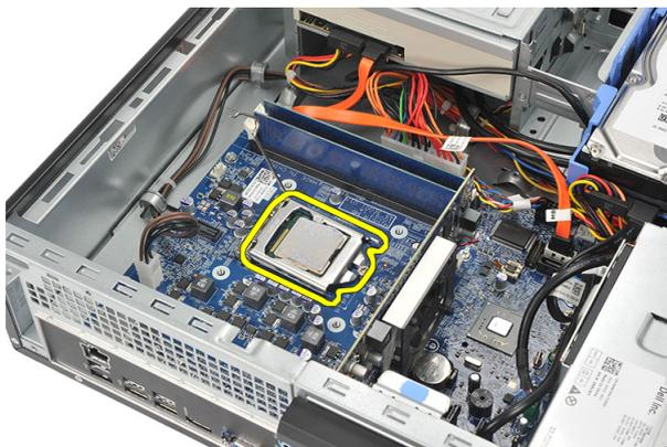
8. Levante o processador para o retirar do encaixe e coloque-o numa embalagem antiestática.
