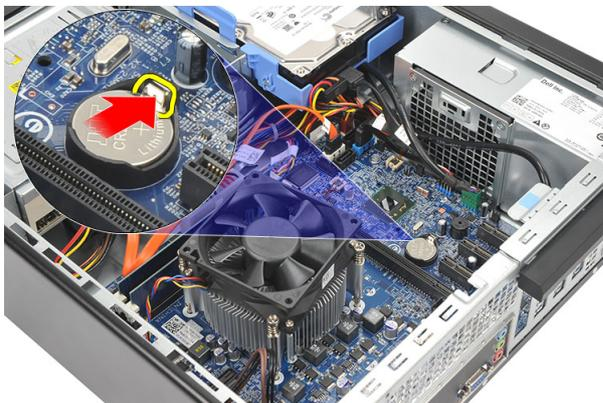
4. Levante a bateria de célula tipo moeda e retire-a do computador.
