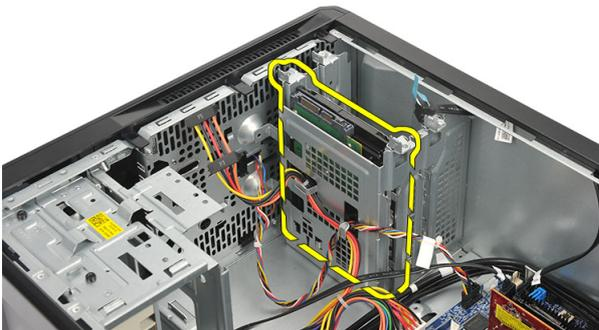
6. Retire os parafusos que fixam o suporte à unidade de disco rígido.
