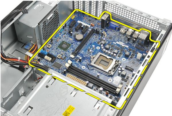
12. Levante a placa de sistema para fora do computador e coloque-a numa embalagem antiestática.
